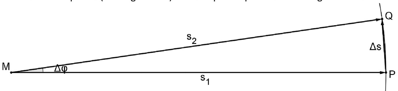
In der kurzen Zeitspanne  $\Delta t$  legt also der Körper auf der Kreisbahn näherungsweise die Strecke  $\Delta s$  zurück, seine Bahngeschwindigkeit beträgt somit  $v = \frac{\Delta s}{\Delta t}$ .
