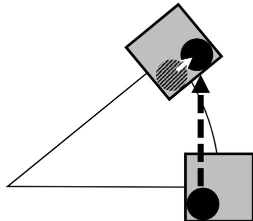
Die Zentrifugal-Scheinkraft wirkt genau entgegengesetzt zur Zentripetalkraft und ist betragsmäßig gleich groß. Im mit uns mitrotierenden Bezugssystem heben sich Zentripetalkraft und Zentrifugalkraft also gegenseitig auf, d.h. wir bleiben an der gleichen Stelle im Raum/Sitz und bewegen uns relativ zu diesem Bezugssystem nicht.
